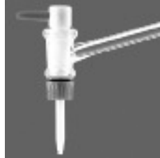
Бюретка с игольчатым краном, наклонная
