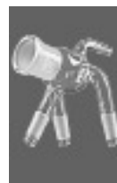
Паук на 3 колбы (NS14/23) с отводом под вакуум
