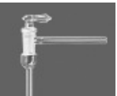
Игольчатый клапан для эксикатора (турбулентция на крышке)
