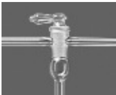
Игольчатый клапан для эксикатора (турбулентция сбоку)
